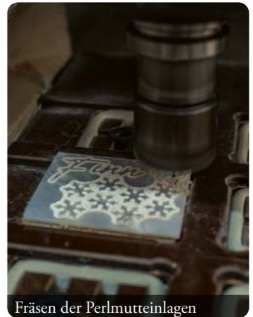
Fräsen der Perlmuttereinlagen
