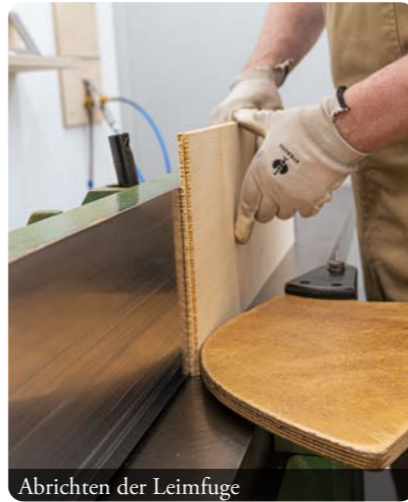
Abrichten der Leimfuge
